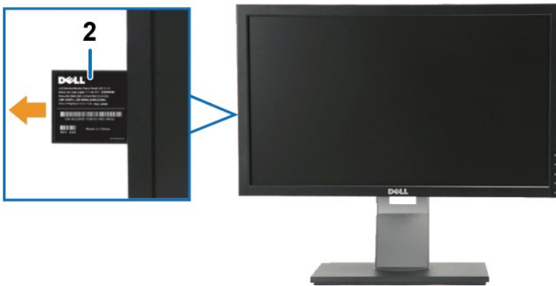
Frontansicht mit herausgezogener Typenschildkarte
